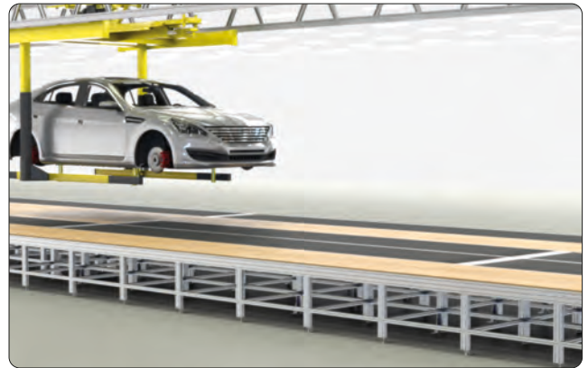
Band-Anordnung mit Podest und mit Unterbau für variable Höhe
